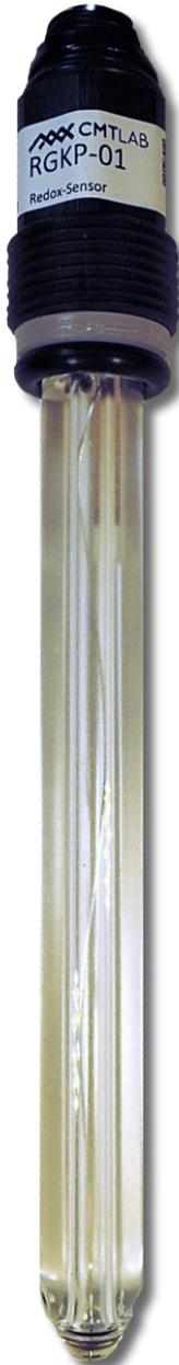
Im Temperaturbereich unter  $-15\text{ }^{\circ}\text{C}$  können die Elektroden durch Gefrieren des Innenpuffers und Innenelektrolyts beschädigt werden.
